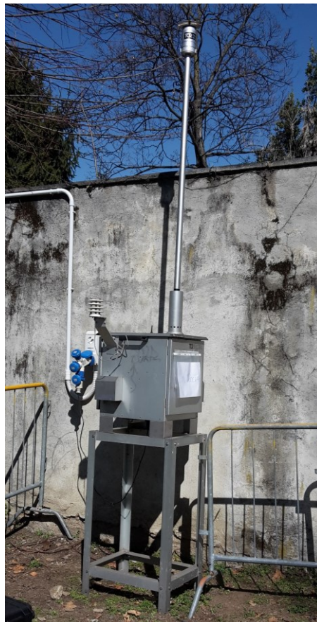
Figura 5 – Campionatore di PM10 utilizzato per il monitoraggio della qualità dell'aria nel comune di Ciriè
