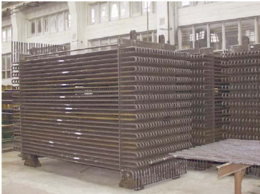
Fasci tubieri surriscaldatori a convezione
