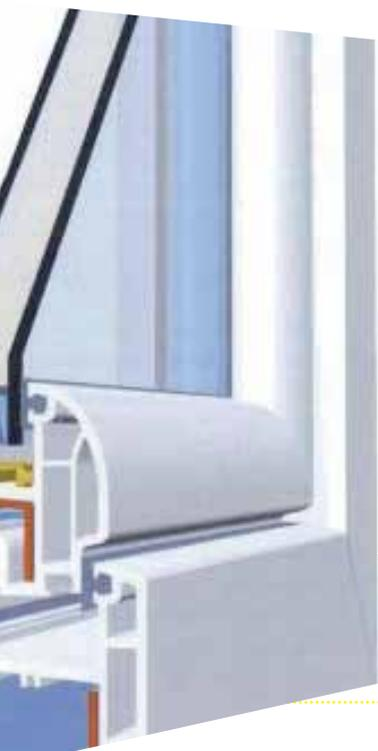
I serramenti in PVC sono buoni isolanti termici: alle naturali proprietà del materiale si aggiunge la morfologia cava del profilo che funziona come una vera e propria camera d'aria, dove il flusso d'aria interno agisce come un isolante termico. I profili in produzione hanno camere d'aria plurime (5-6 camere d'aria), chiuse ermeticamente e abbastanza piccole da evitare la formazione di moti convettivi interni.
